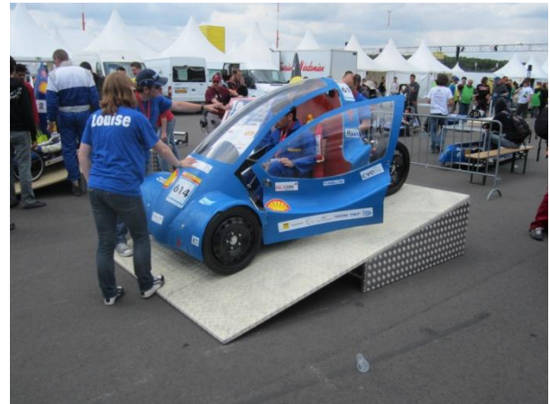
Photo de notre Urban sur pente à 20% pour la vérification des freins.
